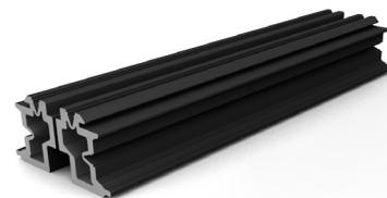
Für eine Terrasse im öffentlichen Bereich müssen die Längsstöße mit Längsverbindern (Abb. 1) verstärkt werden. Ein Top Link sollte angebracht werden und der Längsstoß muss auf einem Stellfuß ausgeführt werden.
