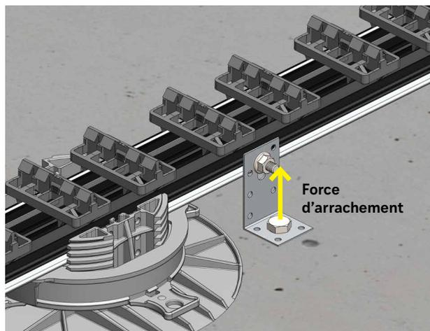
Utilisation d'une équerre ou feuillard avec boulons M6 pour ancrer la terrasse au sol. La fixation se fait en quinconce et le nombre d'ancrages par m<sup>2</sup> peut être déterminé en prenant en compte la force de soulèvement due au vent et au poids propre de la terrasse.
