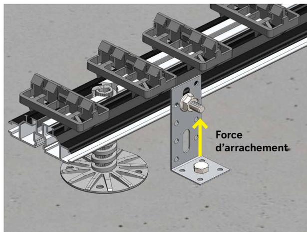
Utilisation d'une équerre ou feuillard avec boulons M6 pour ancrer la terrasse au sol. La fixation se fait en quinconce et le nombre d'ancrages par m<sup>2</sup> peut être déterminé en prenant en compte la force de soulèvement due au vent et au poids propre de la terrasse.
