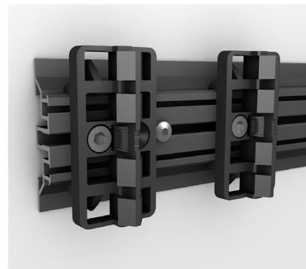
Une fois positionné, le clip peut être maintenu en place à l'aide d'une vis TF M5x12 sur les rails avec rainure centrale taraudée (Flat Rail, PR)
