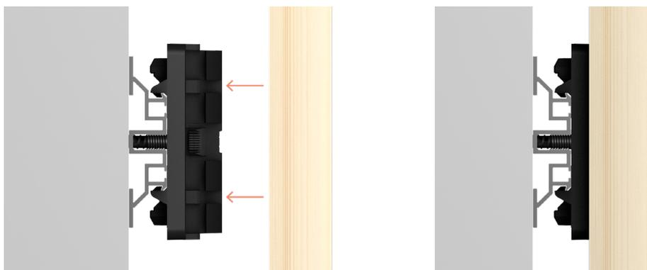
Positionner la lame en face du clip et appliquer une pression pour la mettre en place
