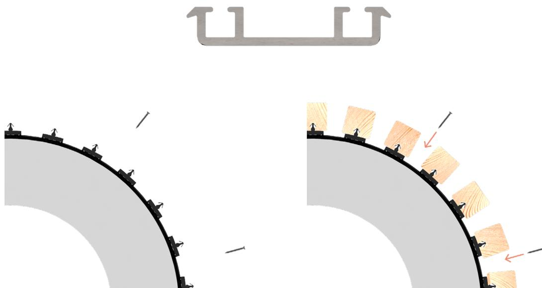
Le système Mini Rail + clip coulissant permet l'ajustement des lames de bardage sur un support courbé.
