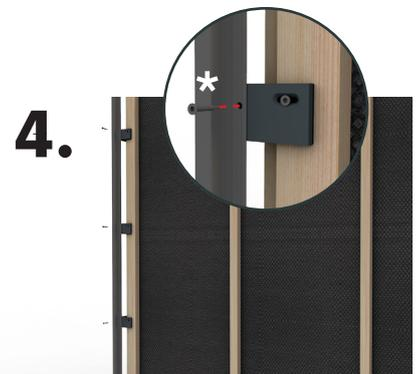
Avant la pose des rails, veuillez à remplacer le premier clip démontable par un demi-clip afin qu'il n'y ait pas de collision entre le profil et le clip, et pré-percer également les rails selon les entraxes de fixation indiqués dans la fiche technique du rail.
