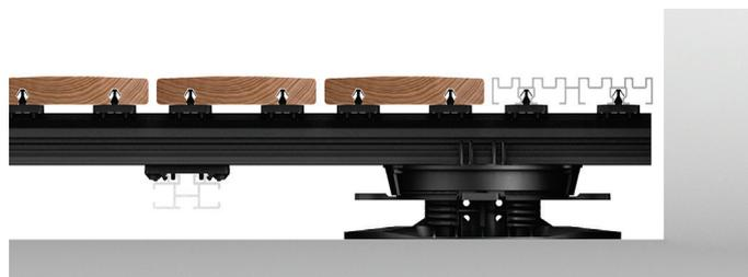
Belüftungs- und Entwässerungsgrost längs der Wand direkt auf die Grad-Clips befestigt.
