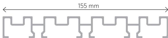
Grad Belüftungs- und Entwässerungsrost aus eloxiertem Aluminium. Geeignet zur Verlegung auf dem Grad-Clipsystem.
