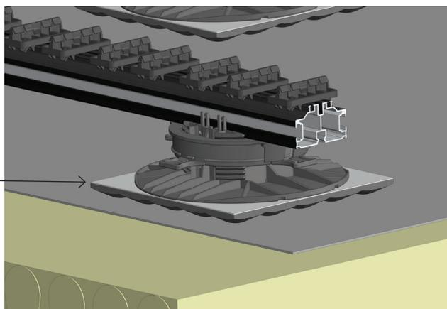
Bautenschutzmatte Terrassenpad alukaschiert. Speziell zum Verlegen auf Bitumenbahnen, Schweißbahnen bzw. Bitumenuntergrund oder Folien. Die Alukaschierung verhindert die Wanderung von Weichmachern.
