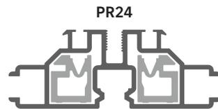
Verbindung von zwei verschiedenen Schienen: Ausgleich von Höhenunterschieden.
