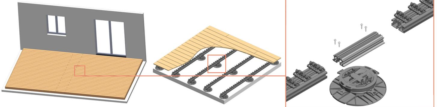
Verbindung 2 gleicher Schienenhöhen : mit dieser starken Verbindung kann die Terrasse mehr Last aufnehmen.
